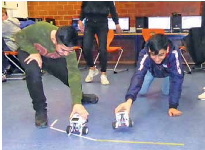
Die Robotik-Freaks Sizar und Amad testen, ob sie ihre Roboterautos für den Linienverlauf auf dem Boden richtig programmiert haben. Foto: hhh
